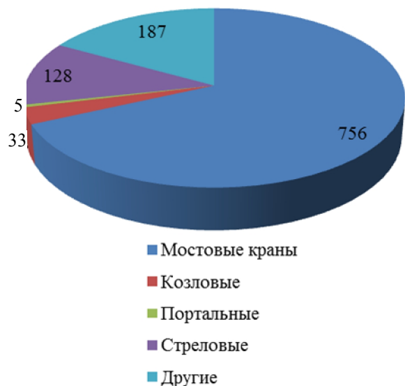
Рис. Крановое хозяйство ПАО «ММК» Fig. Crane facilities of PJSC MMK
