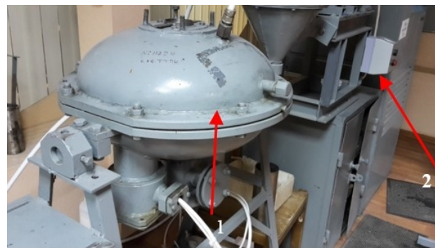
Рис. 4. Установка для механоактивации МУНТ: 1 – рабочий орган; 2 – блок управления Fig. 4. The machine for mechanical activation of MWCNT: 1 is a working body; 2 is a control unit
