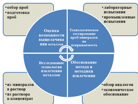
Рис. 3. Алгоритм обоснования параметров блокового выщелачивания
