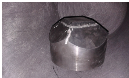
Рис. 4. Отходы твердых сплавов (наковальня для производства синтетических алмазов), загруженные в холодную зону реактора
