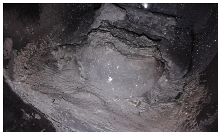
Рис. 5. Продукт, полученный в реакторе после первичной деструкции
