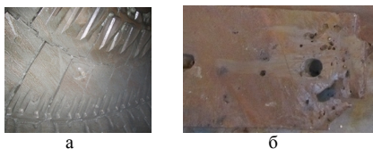
Рис. 1. Износ броней торцевой загрузочной стенки (а) и дефекты литья, выявленные в процессе эксплуатации (б)
