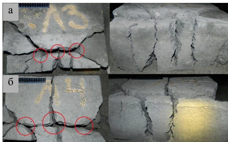
Рис. 4. Картина разрушения при взрыве 3-х зарядов с замедлением на центральный заряд: а – с коэффициентом сближения 1; б – с коэффициентом сближения 2
