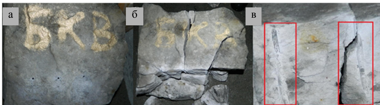
Рис. 6. Взрывание кварца: а – негабаритный кусок гранулированного кварца с подготовленными мини-шпурами; б – картина разрушения при взрыве 3-х зарядов с коэффициентом сближения 1,0; в – полости минишпуров после взрыва
