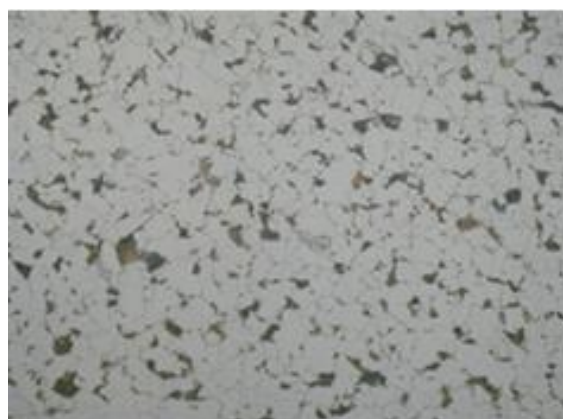
Рис. 9. Микроструктура образца стали Св-08Г2С – изотерма при 550°С в течение 20 мин, \times 500
