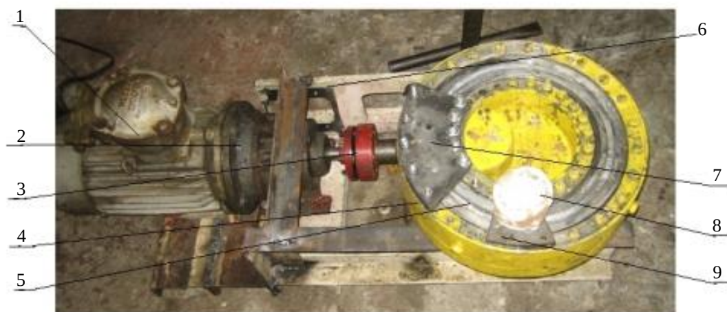
Рис. 2. Установка непрерывного литья-прессования методом conform
