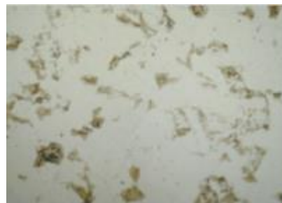
Рис. 15. Основная структура катанки из стали Св-08ХГ2СМФ ( t = 600^\circ\text{C} , \tau = 30 мин), \times 500
