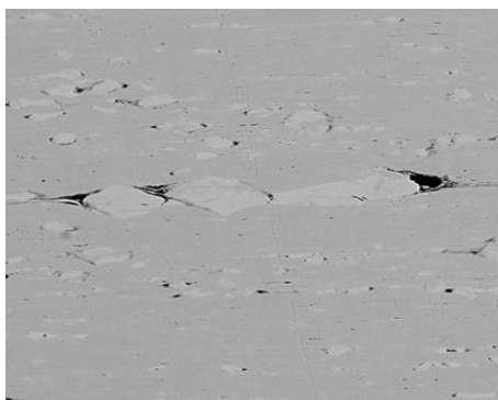
Рис. 10. Трещины у бейнитно-мартенситных участков в проволоке диаметром 1,0 мм из стали Св-08Г2С как инициаторы обрыва проволоки
