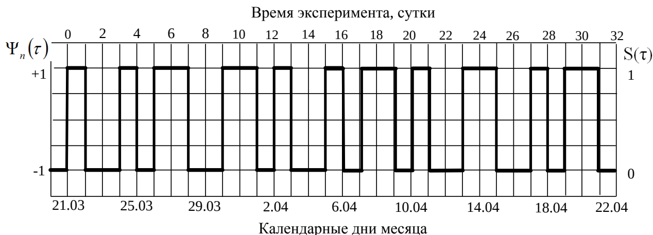
Рис. 3. Календарный график переключения способов управления тепловым режимом методической печи
