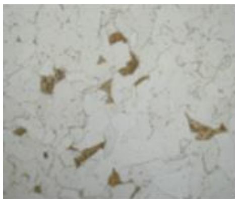
Рис. 14. Микроструктура по сечению катанки из стали Св-08ХГ2СМФ ( t = 700^\circ\text{C} , \tau = 20 мин.), \times 500 : а – поверхностной зоны; б – основная структура
