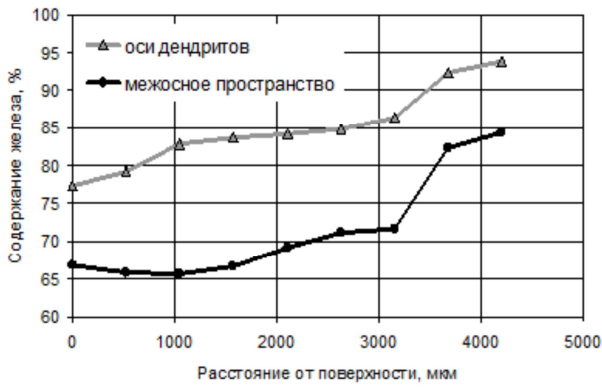
Рис. 8. Распределение концентрации железа по толщине покрытия
