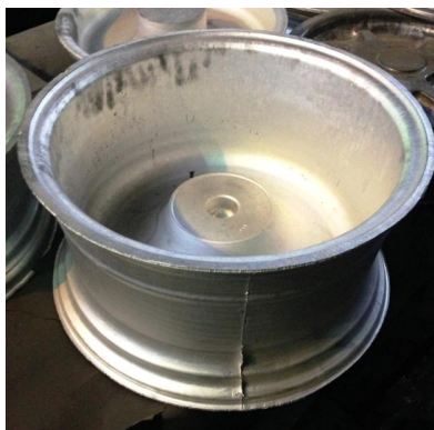
Рис. 2. Штампованная поковка «Диск» из сплава АВ
