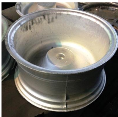
Рис. 2. Штампованная поковка «Диск» из сплава АВ
