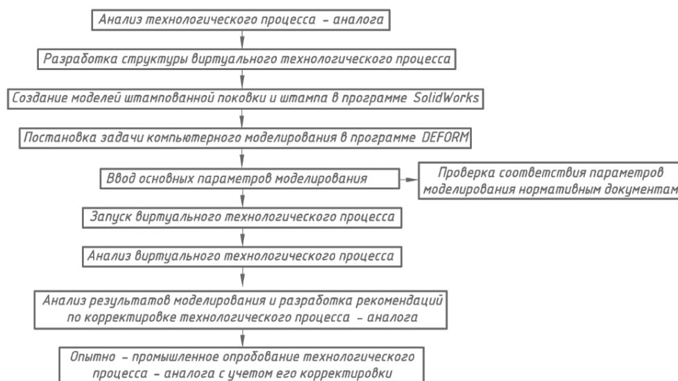
Рис. 1. Порядок моделирования горячей объемной штамповки поковок из алюминиевых сплавов
