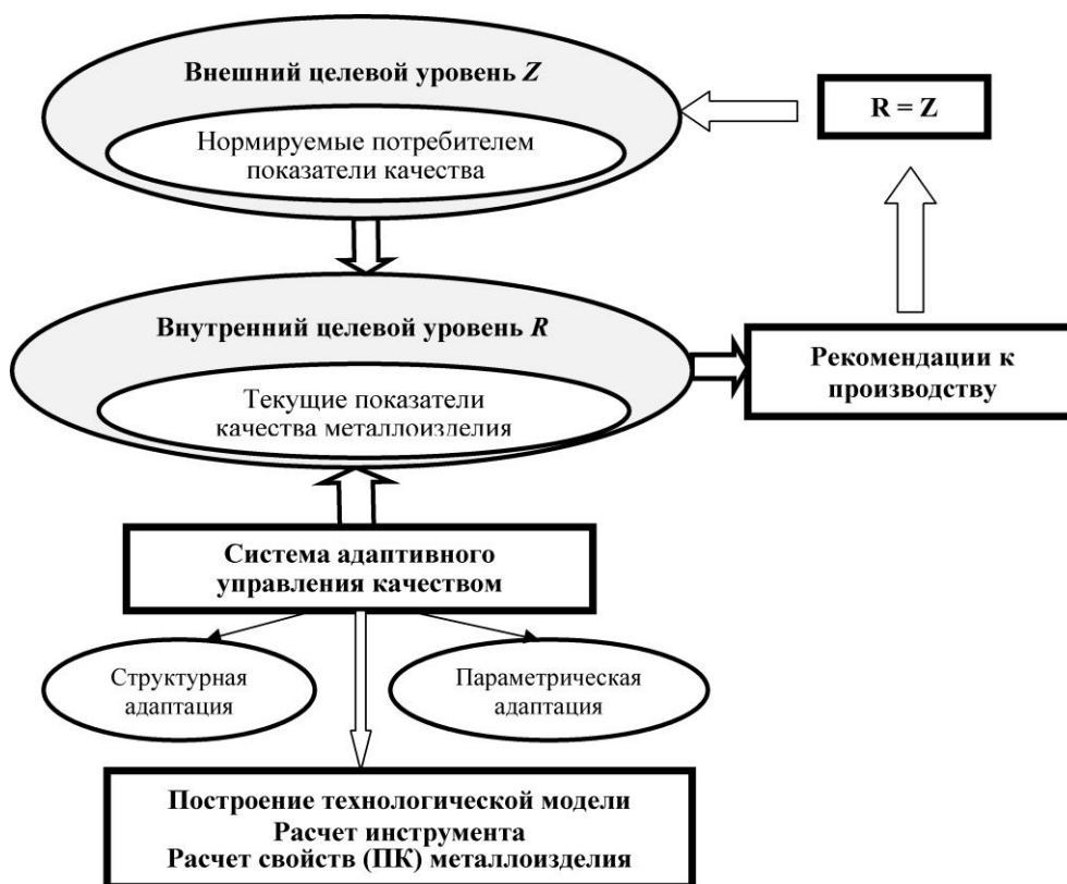
Рис. 1. Структурная модель технологической адаптации показателей качества металлопродукции
