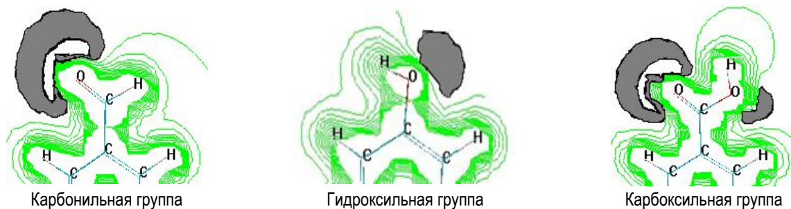
Рис. 3. Проекционные карты МЭСП функциональных групп поверхности ОМУ
