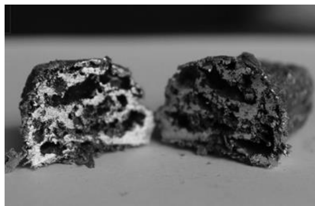
Рис. 4. Поперечный разрез образца пресс-изделия после вспенивания
