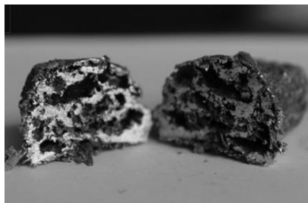
Рис. 4. Поперечный разрез образца пресс-изделия после вспенивания
