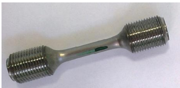
Рис. 5. Образец для определения RS_1 в сплавах ВТ6
