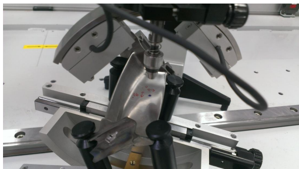
Рис. 6. Закрепление лопатки турбины ГТД в специальном приспособлении
