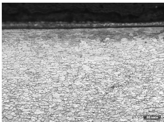
Рис. 3. Микроструктура образца с плазменно-электролитным покрытием, \times 200
