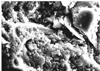
Рис. 7. Микроструктура излома напольного кокса 2, x850
