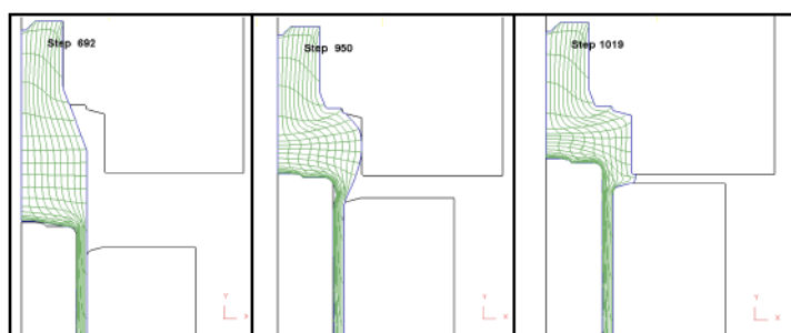
Рис. 8. Трансформация координатной сетки заготовки на этапах четвертого перехода усовершенствованной схемы ХОШ
