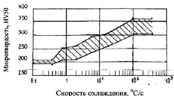
Рис. 4. Микротвердость дилатометрических образцов, охлажденных со скоростями 0.1; 0.36; 0.8; 2.0; 5.5; 14.0; 104.0; 350.0°C/c (верхняя кривая – максимальное, нижняя – минимальное значения)
