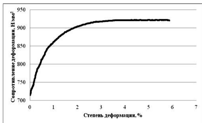
Рис. 1. Диаграмма растяжения стали марки 80P при температуре 400°C
