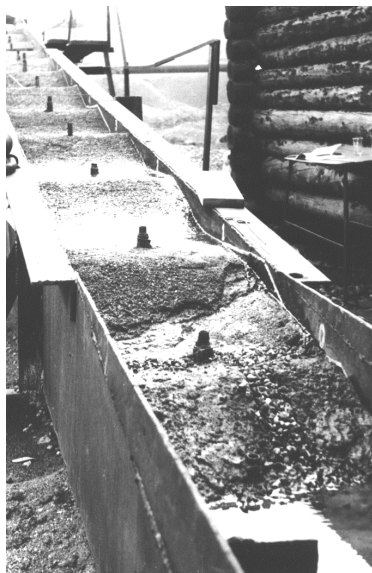
Рис. 2. Общий вид полупромышленной установки физического моделирования процессов фильтрации в масштабе 1:20
