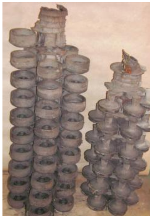
Рис. 5. Отливки рабочих колёс (а) и направляющих аппаратов (б), полученных методом столочного литья
