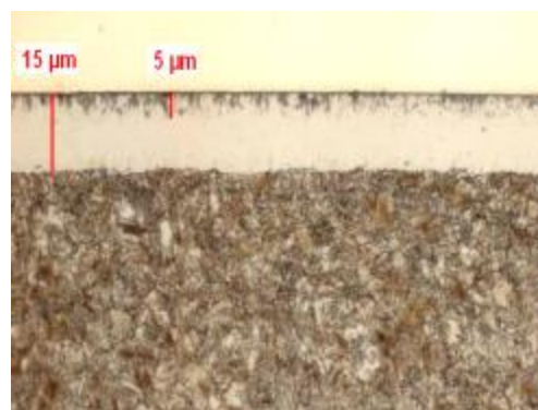
Рис. 1. Структура стали 09Г2С после карбонитрации, t=570^\circ\text{C} , \tau=2 ч
