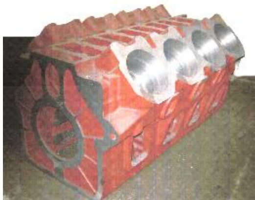
Рис. 3. Блок (картер) 8-цилиндрового дизеля 8ДМ21 из чугуна с вермикулярным графитом (обработка модификатором Vermitloy). Масса отливки ≈4500 кг, толщина стенок 10–80 мм
