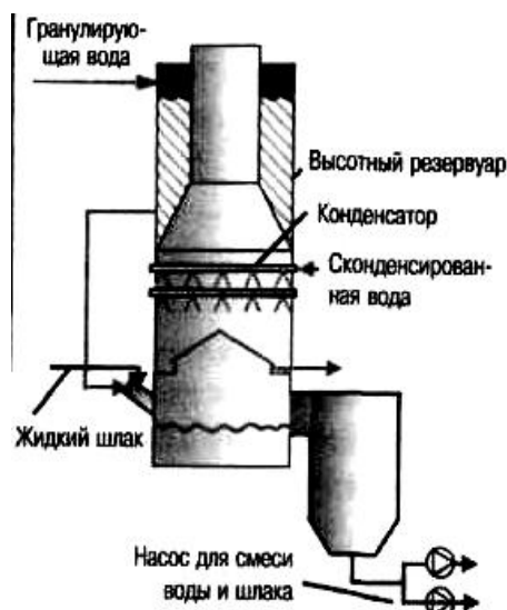
Рис. 2. Схема башни для грануляции шлака [7]
