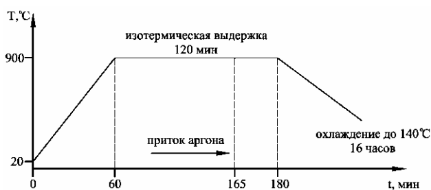
Рис. 1. Температурно-временной режим термической обработки прутка сечением 1,05×1,05 мм
