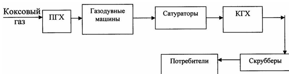
Рис. 2. Схема последовательно работающих агрегатов в ЦУ-1
