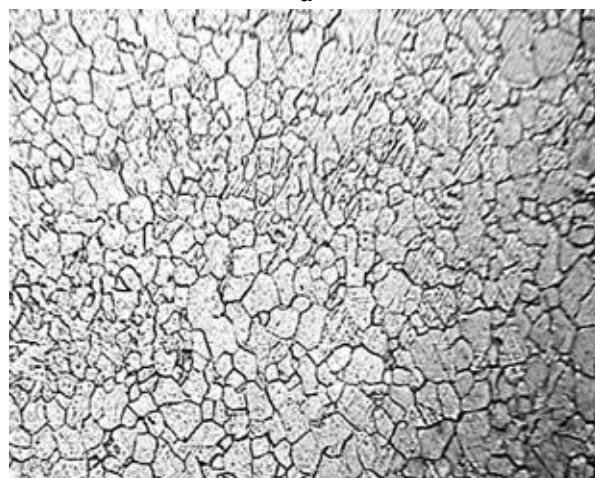
Рис. 1. Микроструктура образца D = 5,0 мм, подвергнутого десятикратной РКУПротяжке с предварительным отжигом, \times 200 : а – поверхность; б – центр
