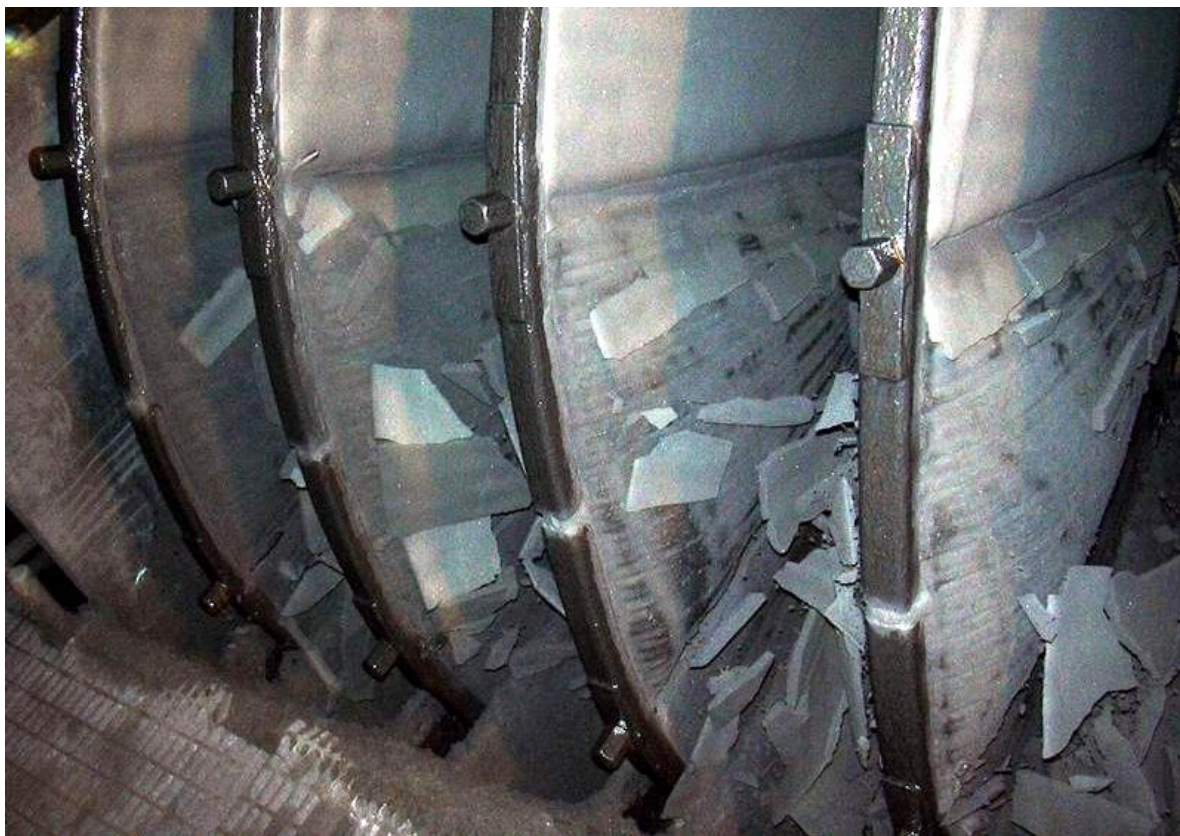
Рис. 3. Съем осадка при импульсной отдувке
