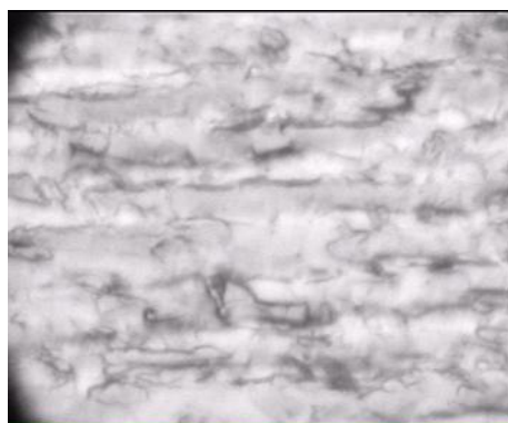
Рис. 3. Структура заготовки при степени укова y=36 , \times 650
