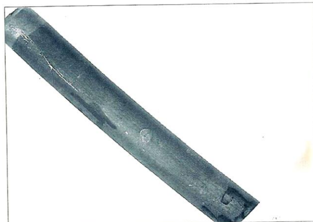
Рис. 6. Внешний вид поверхности катанки диаметром 9 мм из низкоуглеродистой стали 1008 после травления; t_{в/у} \approx 1000^\circ\text{C}
