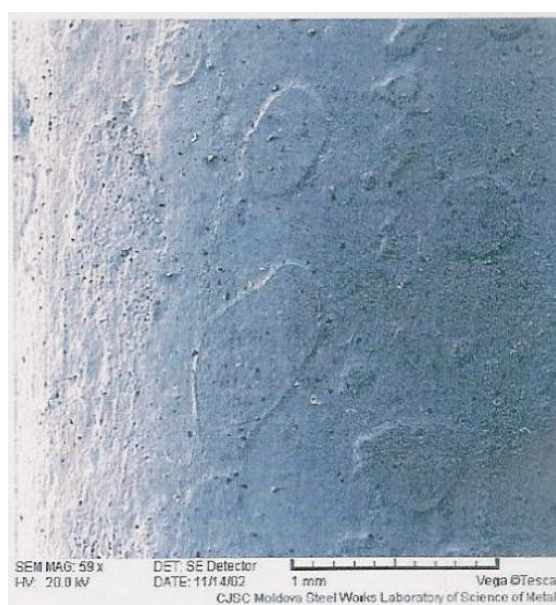
Рис. 4. Полностью вытравленная окалина на поверхности катанки: выпуклые участки ( Fe_3O_4 ) имеют большее время травления:
