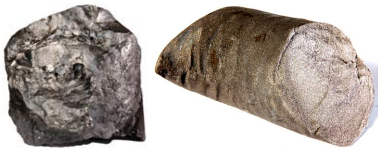
Азотированный хром СВС (слева – проплавленный, справа – спеченный)
