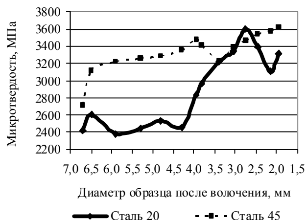
Рис. 11. Изменение твердости при волочении наноструктурированных сталей
