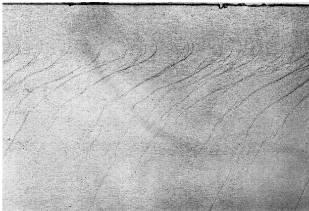
Рис. 1. Внешний вид дефекта «излом»
