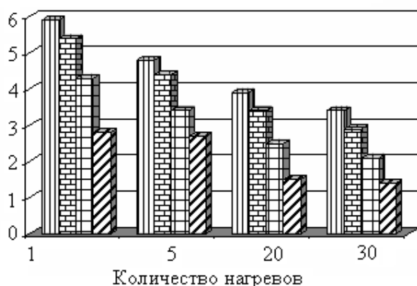
Рис. 2. Гистограмма удельных потерь тепла для различных электродов в зависимости от количества нагревов: – сплошной электрод; – полые электроды с диаметром отверстия 10, 20 и 30 мм соответственно
