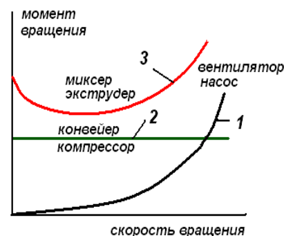
а Рис. 2. Распределение асинхронных электродвигателей по механизмам и типовые характеристики основных механизмов
