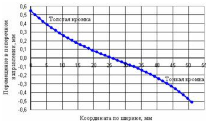
Рис. 5. Перемещение частиц металла в поперечном направлении
