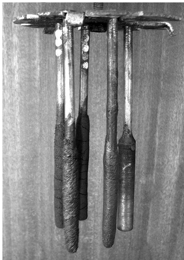
Рис. 2. Вид образцов в кассете после сушки в сушильном шкафу при температуре 75–85°C ( \tau = 1 ч)
