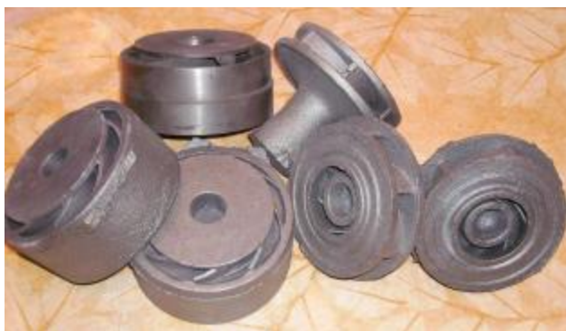
Рис. 1. Отливки рабочих колёс и направляющих аппаратов, залитые из нирезиста с шаровидным графитом
