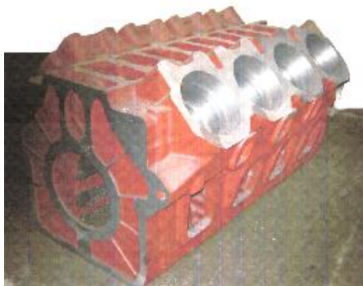
Рис. 3. Блок (картер) 8-цилиндрового дизеля 8ДМ21 из чугуна с вермикулярным графитом (обработка модификатором Vermiloy). Масса отливки ≈ 4500 кг, толщина стенок 10–80 мм
