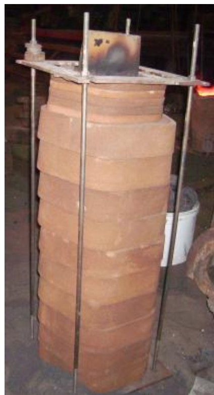
Рис. 4. Стопка форм, подготовленных к заливке
