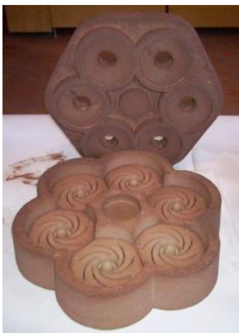
Рис. 2. Многоместная песчаная форма рабочих колес и направляющих аппаратов
