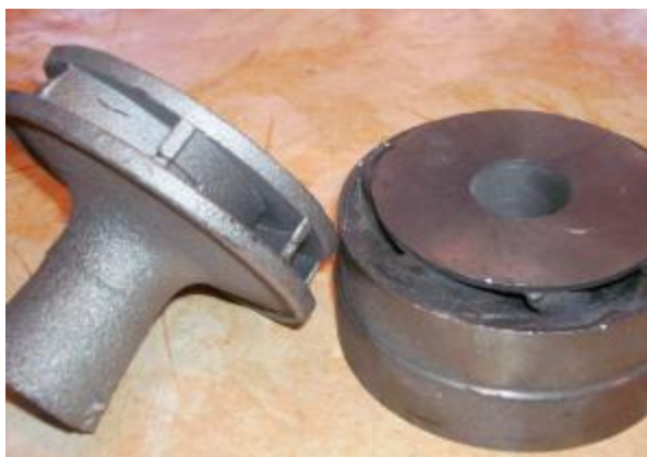
Рис. 3. Неспай и недоливы на лопатках рабочего колеса и направляющего аппарата
