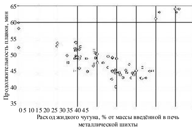
Рис. 1. Зависимость средней продолжительности плавки полупродукта для получения стали марки Ст. 3сп в дуговой сталеплавильной печи вместимостью 180 т от расхода жидкого чугуна в шихте до 41% (отн.)
