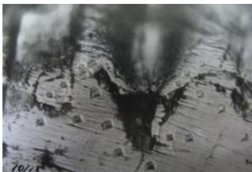
Рис. 2. Косой срез под углом 15^{\circ} (по оплавленному дефектному пятну); сплав ТС5, \times 385
