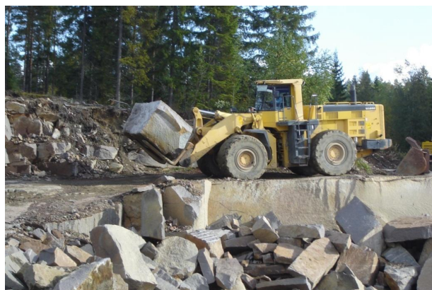
Рис. 3. Транспортировка блоков погрузчиком WA600
