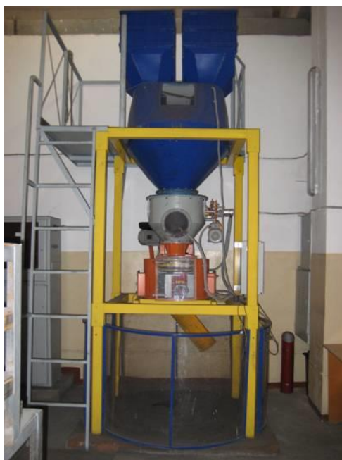
Рис. 1. Физическая модель однотрактового компактного загрузочного устройства лоткового типа
