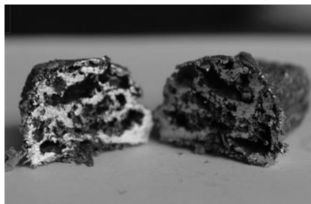
Рис. 4. Поперечный разрез образца пресс-изделия после вспенивания
