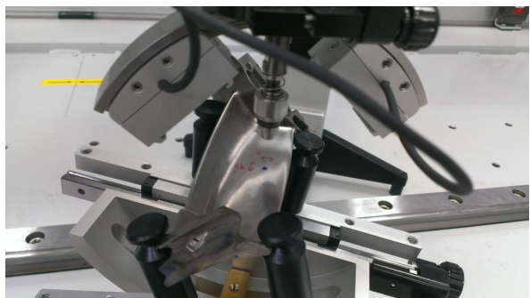
Рис. 6. Закрепление лопатки турбины ГТД в специальном приспособлении
