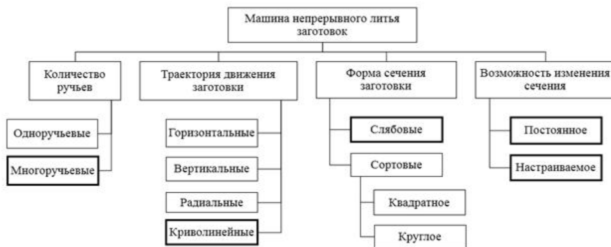
Рис. 1. Схема классификации машин непрерывного литья заготовок
