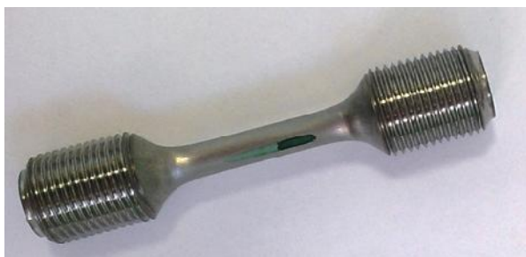
Рис. 5. Образец для определения RS_1 в сплавах ВТ6
