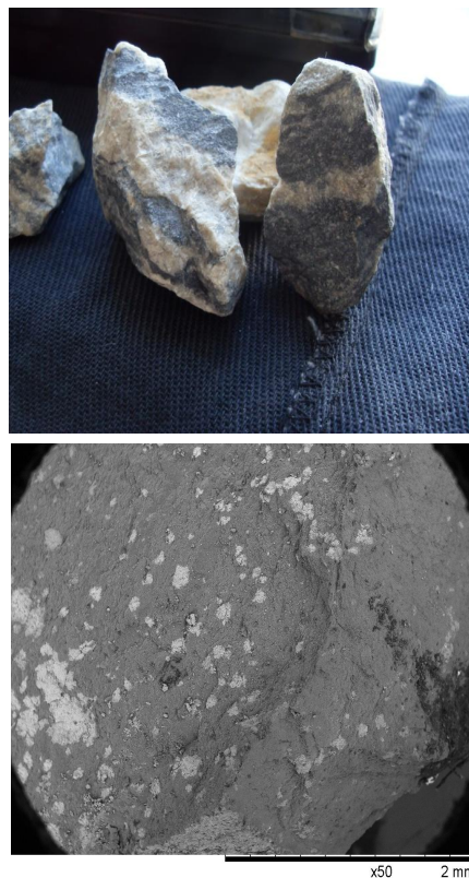
Рис. 1. Макро- и микровключения нерудных материалов в бакальской руде
