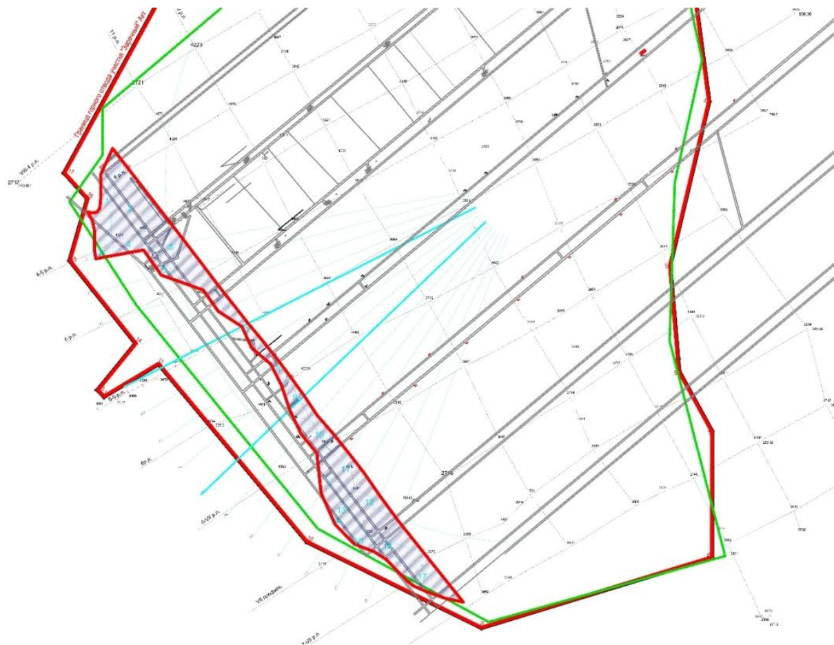
Рис. 4. Месторасположение целика для обеспечения безопасности подземных работ
