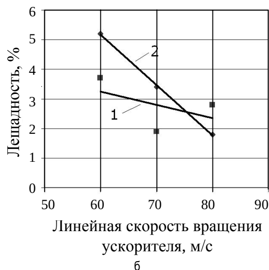
Рис. 3. Зависимость содержания лещадных зерен от линейной скорости вращения ускорителя для различных фракций и материалов: а – гранит ДС-0.4 (1 – 10–20 мм; 2 – 5–10 мм); б – гравий ДС-0.4 (1 – 10–15 мм; 2 – 5–10 мм)
