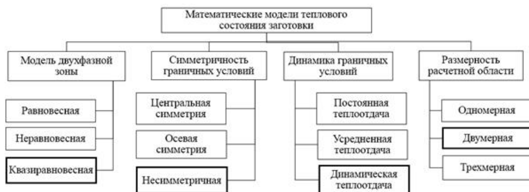
Рис. 4. Схема классификация математических моделей для описания теплового состояния заготовок
