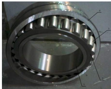
Подшипник тянущего ролика стана 2000 холодной прокатки SKF 200/310x82, тип 23040 CC/W33/C3
