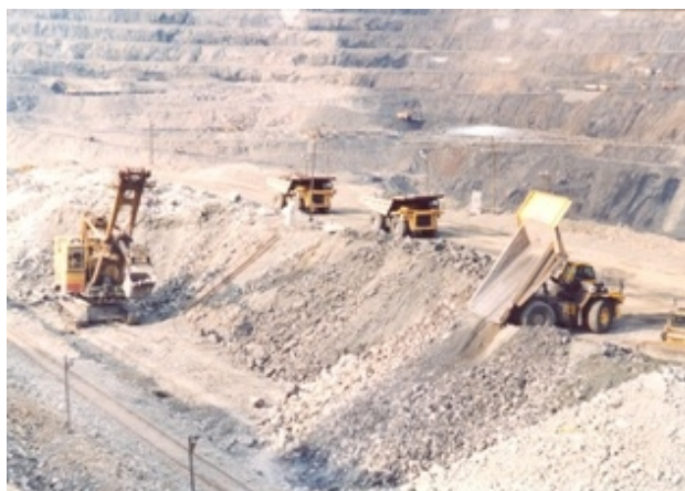
Рис. 4. Перегрузочно-усреднительный склад железной руды в карьерах Северного Казахстана
