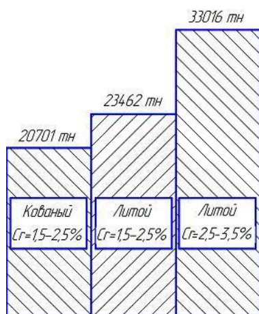
Рис. 2. Диаграмма стойкости валков 500х1200 разных исполнений и с различным содержанием хрома
