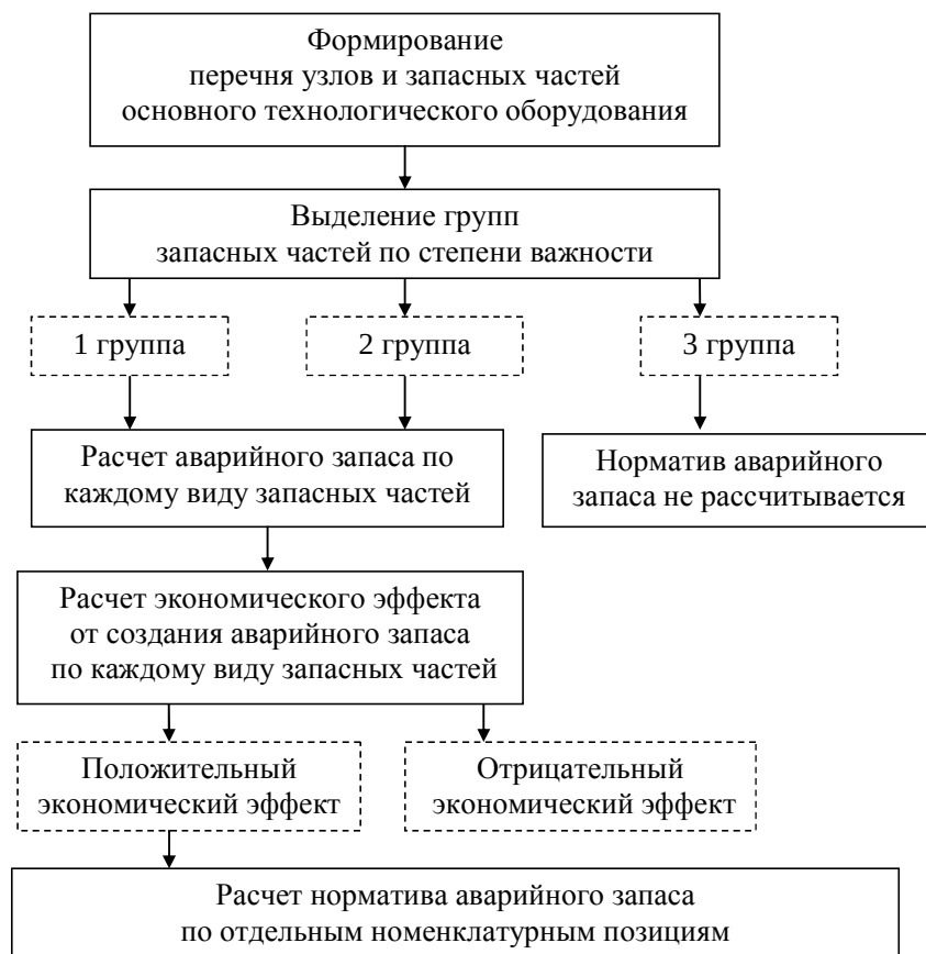
Рис.3. Алгоритм автоматизированного расчета норм и норматива аварийного запаса запасных частей
