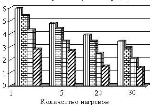
Рис. 2. Гистограмма удельных потерь тепла для различных электродов в зависимости от количества нагревов: – сплошной электрод; – полые электроды с диаметром отверстия 10, 20 и 30 мм соответственно
