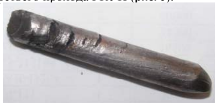
Рис. 9. Заготовка, полученная после трёх проходов РКУП
