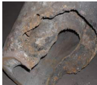
Рис. 1. Характер прогара воздушной фурмы
