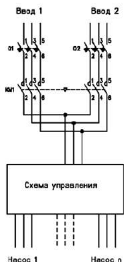
Рис. 1. Схема автоматического перевода насосов на резервное электропитание
